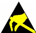
Bei den XLR-Anschlüssen sind elektrostatische Entladungen zu vermeiden, um eventuellen Schäden an den Relais im Signalweg vorzubeugen!
